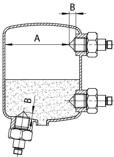
Einbau in einer Rohrleitung für Pumpentrockenlaufschutz. A ≥ 40 mm
